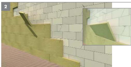
L'isolation doit être posée de façon à ce que l'ensemble de la surface de façade, les détails et les raccords répondent aux exigences maximales en matière de valeur U. Poser les panneaux en quinconce en les appuyant légèrement les uns contre les autres.
